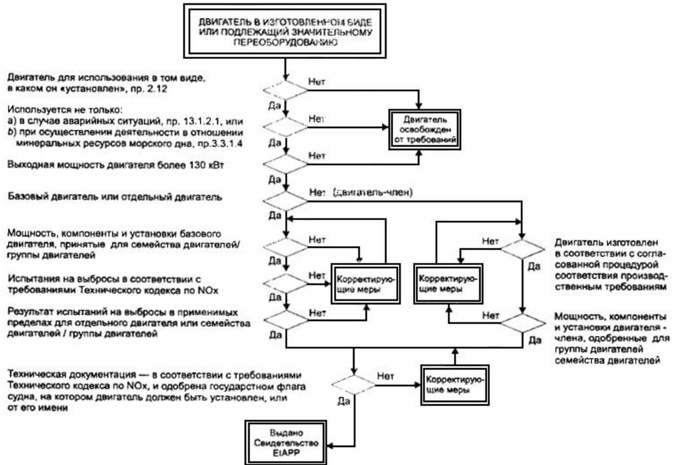
Рис.1. Предварительное сертификационное освидетельствование на предприятии изготовителя
