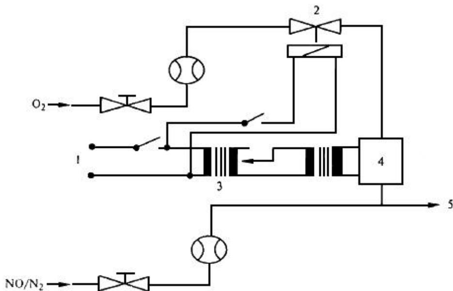
Рис.1. Схема устройства для определения кпд конвертера  $\text{NO}_2$
